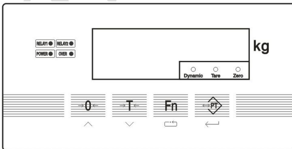
XK3101 电子称重仪表显示面板上布置了四个按键，用于仪表的各种操作及参数设定。
