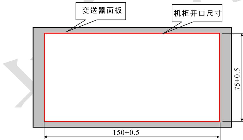
安装前请先将外壳两侧的顶杆拆下,然后将称重终端装入机柜中。将两只顶杆固定在称重终端两侧,要求顶紧仪表外壳以保证牢固安装。
